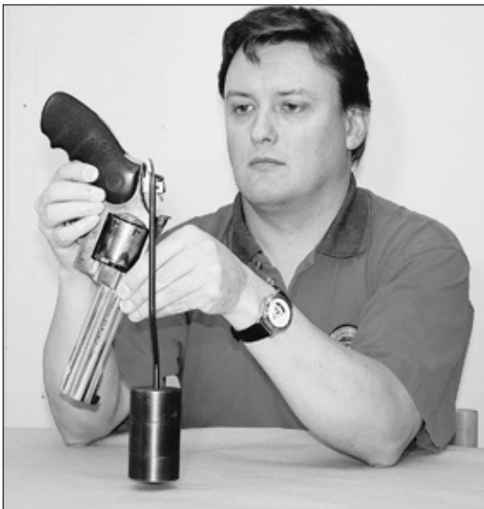
Bild 2: Kontroll av upphakningsmotstånd.
