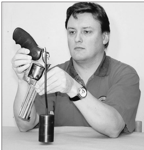
Bild 5: Kontroll av upphakningsmotstånd.
